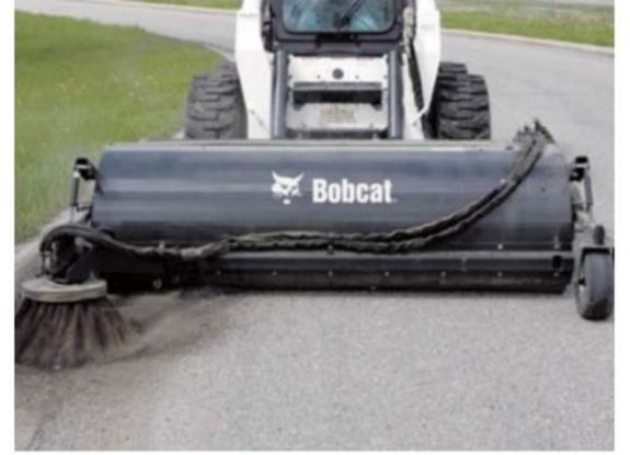
路面のゴミを効率的に掃き込み運搬
